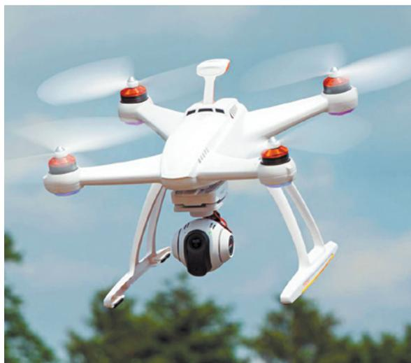
несущим и хвостовым винтом. Однако для небольших гражданских дронов схема квадрокоптера оказалась как нельзя более подходящей: выяснилось, что для аппаратов небольших размеров ее сделать проще, чем повторить в миниатюре привычную вертолетную компоновку. Мультивинтовая конструкция в сочетании с бортовым компьютером, отвечающим за стабилизацию аппарата, позволила создать высокоманевренные дроны, легко зависающие в воздухе и при этом интуитивно управляемые.
